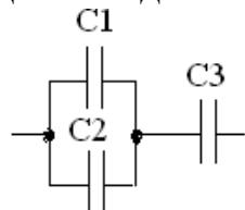
A.  $C_{общ} = C1 + C2 + C3$     B.  $C_{общ} = \frac{(C1+C2)C3}{C1+C2+C3}$     B.  $C_{общ} = \frac{(C3+C2)C1}{C1+C2+C3}$
